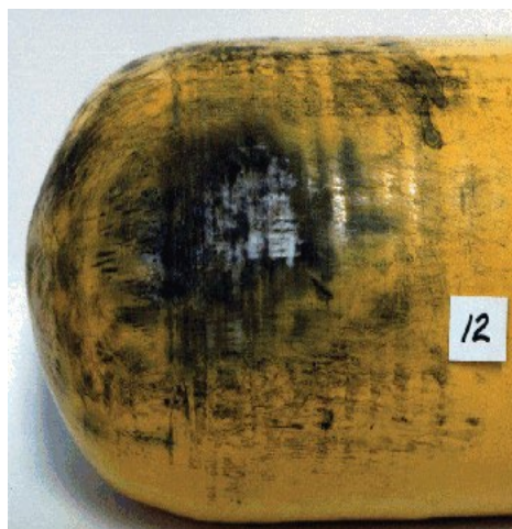
Imagem 6: Dano por Calor e Fogo
