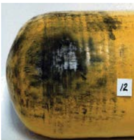
Slika 6: Poškodbe zaradi toplote in ognja
