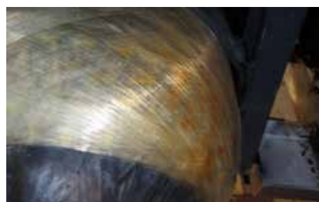
Figure 7 : Dommages inacceptables causés par la chaleur (type 3A à gauche, type 3B à droite)
