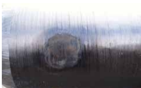
Figure 7 : Dommages inacceptables causés par la chaleur (type 3A à gauche, type 3B à droite)
