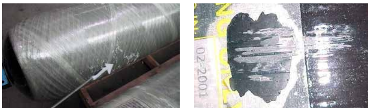
Figure 2 : Dommages dus à l'abrasion (bouteille de type 3B à gauche. Type 3A à droite)
