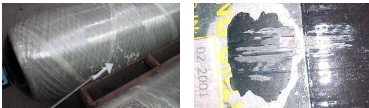
Figura 2: Danni da abrasione (bombole tipo 3B a sinistra. Tipo 3A a destra)
