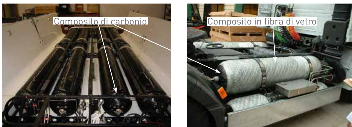
Figura 1: Bombole in composito di carbonio (Tipo 3a - sinistra) e composito in carbonio/fibra di vetro (tipo 3B - destra)
