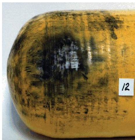
Figura 6: Daño por calor o fuego
