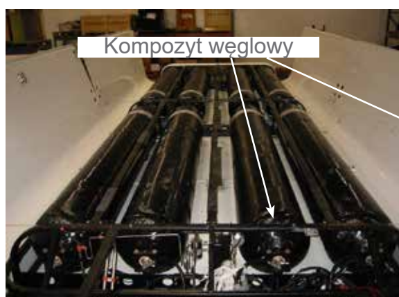
Rysunek 1: cylindry z kompozytu węglowego (typ 3a po lewej) oraz kompozytu z włókna węglowego i szklanego (typ 3b po prawej)
