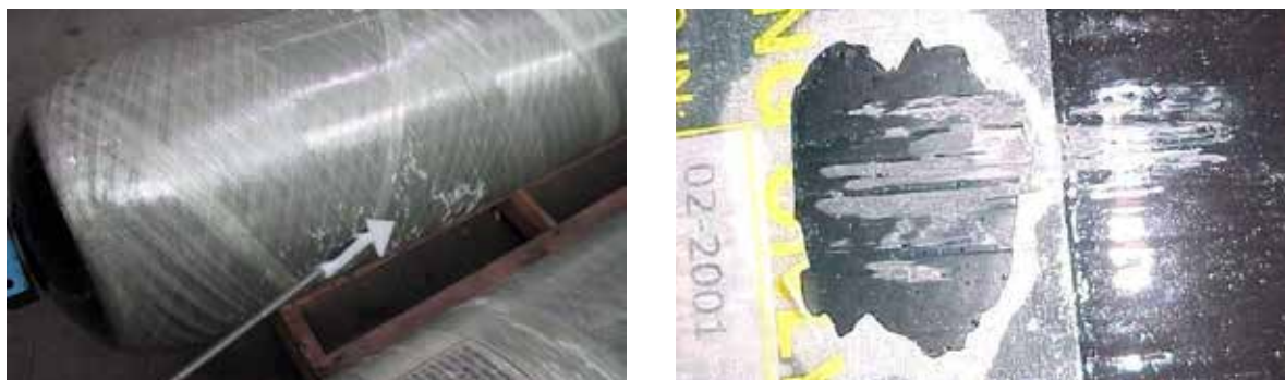
Rysunek 2: Uszkodzenia spowodowane tarciem (cylinder typu 3B po lewej, cylinder typu 3A po prawej)
