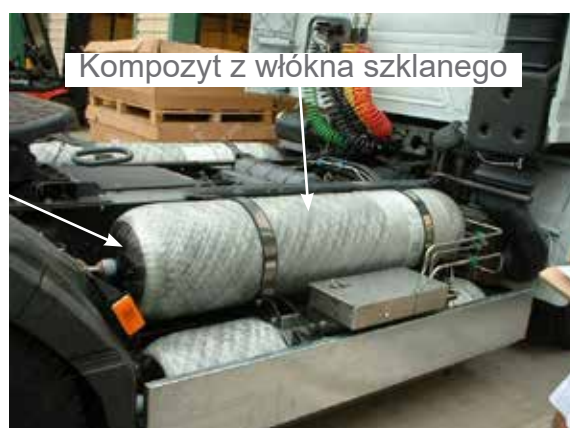
Rysunek 1: cylindry z kompozytu węglowego (typ 3a po lewej) oraz kompozytu z włókna węglowego i szklanego (typ 3b po prawej)
